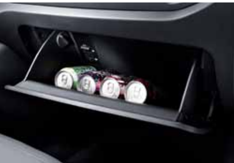
Handschuhfach gekühlt über die Klimaanlage
