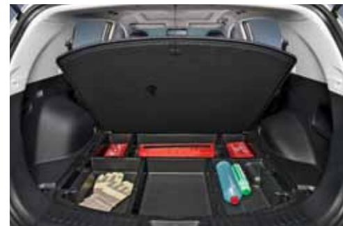
Gutes Versteck: Das Staufach im Laderaumboden (nur bei 2WD Modellen / 4WD Modelle mit vollwertigem Ersatzrad)
